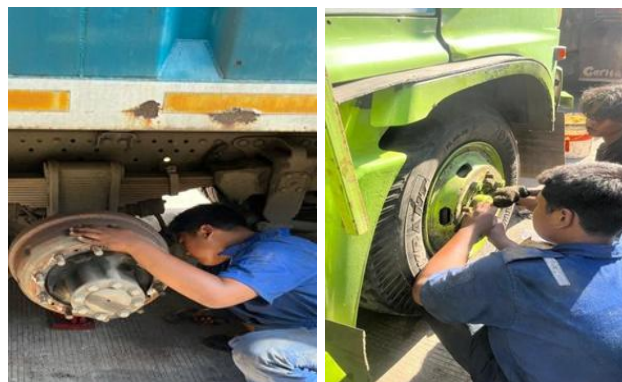
Gambar 1. Penggantian Kampas Rem dan Perawatan Sistem Roda Kendaraan
