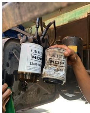
Gambar 2. Penggantian Saringan Solar Pada Unit Hino 500
