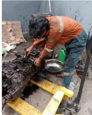
Gambar 5. Perawatan Sistem Transmisi Kendaraan Operasional
