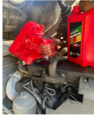
Gambar 3. Penggantian Oli Engine Kendaraan Operasional
