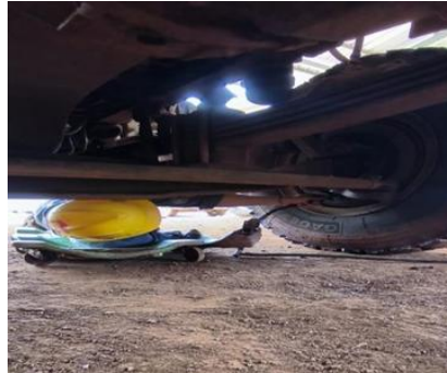
Gambar 1. Greasing pada Komponen Unit Operasional
