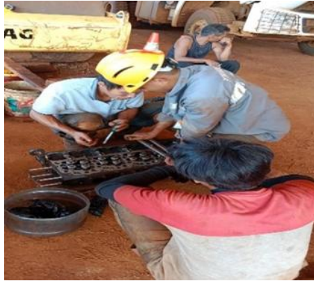
Gambar 4. Memasang Valve , Valve Rotator , Spring , dan Cotter pada Cylinder Head
