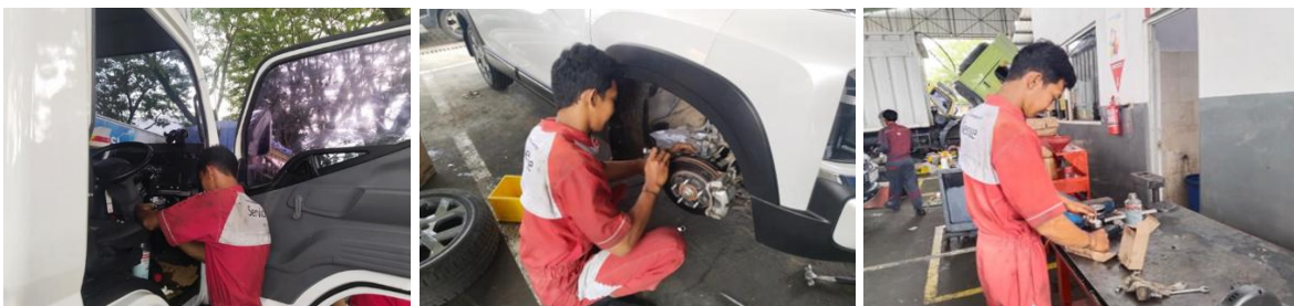
Gambar 1. Pemasangan Master Rem Atas, Pemasangan Sensor ABS, Dan Pemasangan Tie Rod
