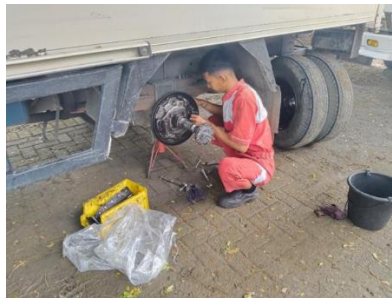
Gambar 3. Pemasangan Bak Rem Belakang
