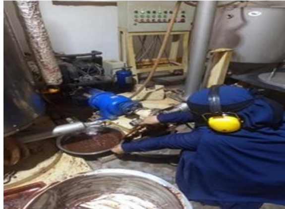
Gambar 3. Pembuatan Pasta Halus Menggunakan Ball Mill
