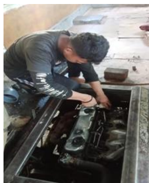
Gambar 2. Penggantian Sil (Karet) Kaper Klep
