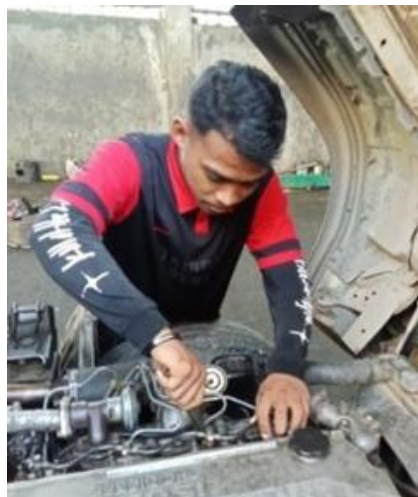
Gambar 4. Pemplendingan Pipa Nossel (Bahan Bakar Solar) Mobil
