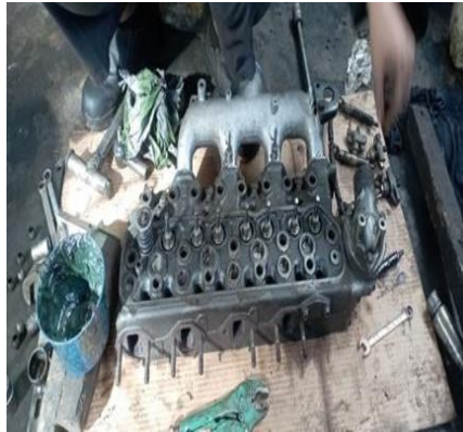
Gambar 3. Penggantian Sil Klep dan Pembersihan Cylinder Head
