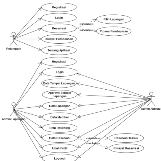
Gambar 2 Use case diagram yang diusulkan
