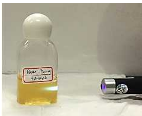
Gambar 2. Pendaran CDs Pisang dalam Cahaya Tampak yang Dieksitasi dengan Sinar Laser Biru
